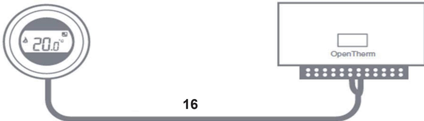
16. - Resistenza max del cavo 2 x 5 Ohm e lunghezza max del cavo 50 m.
